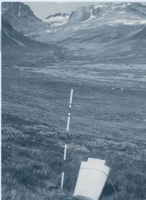
Automatisk sporstofstation ved Kvanefjeld i Sydgrønland.
