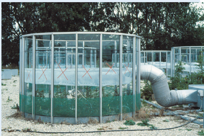
Åben top kamre som forsynes med kontrolleret luftforurening.
